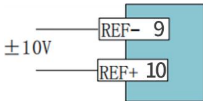
图4.3.2 外部电源模拟量输入接线
