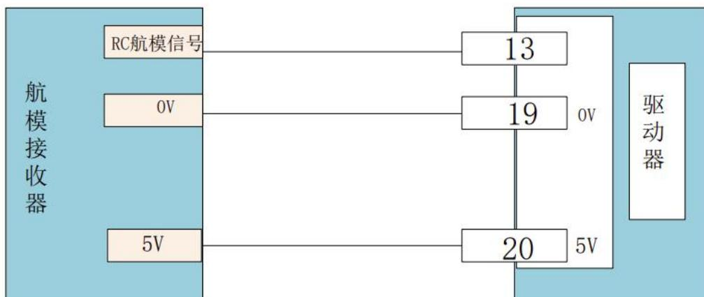
图 4.4.7 RC航模信号接线图
