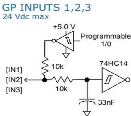
图 4.4.1 IN 1- IN 3 硬件输入电路
