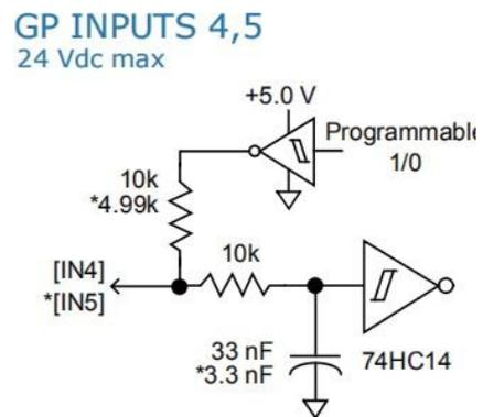
图 4.4.2 IN 4- IN5 硬件输入电路
