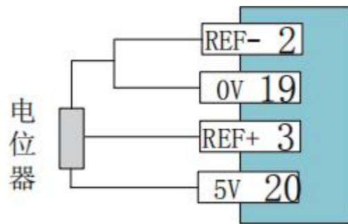
图4.3.3 内部电源模拟量输入接线
