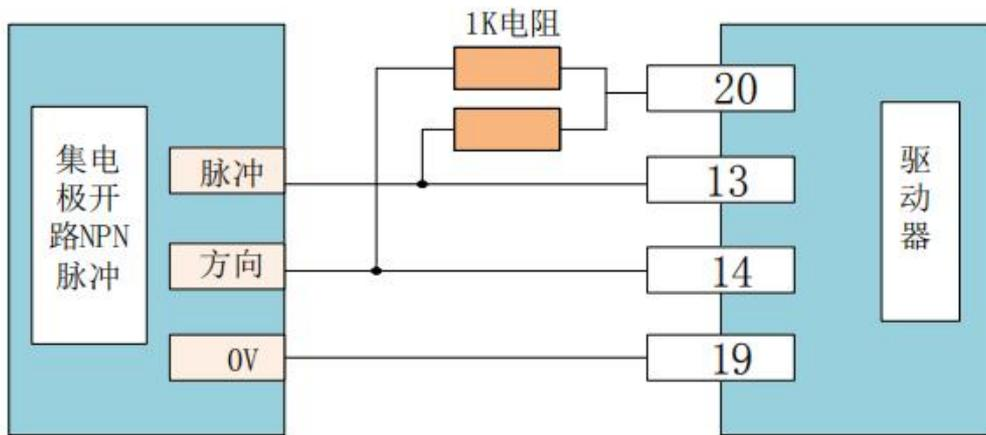
图 4.4.5 集电极开路NPN脉冲输入图
