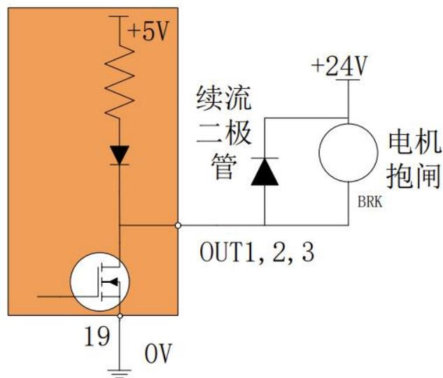
图 4.5.1 电机抱闸制动器外接电路
