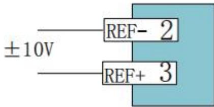
图4.3.2 外部电源模拟量输入接线
