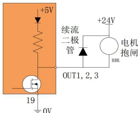
图 3.6.2 电机抱闸制动器外接电路
