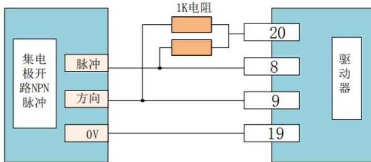
图 3.5.1 集电极开路NPN脉冲输入图
