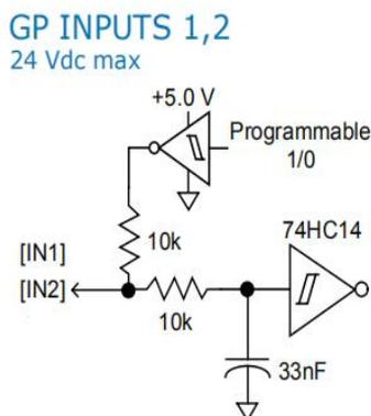
图3.4.1 IN 1- IN 2硬件输入电路
