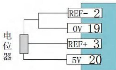
图3.2.3 内部电源模拟量输入接线
