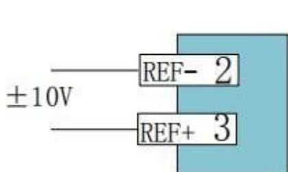
图3.2.2 外部电源模拟量输入接线
