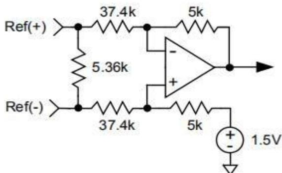
图 3.2.1 模拟量硬件输入电路
