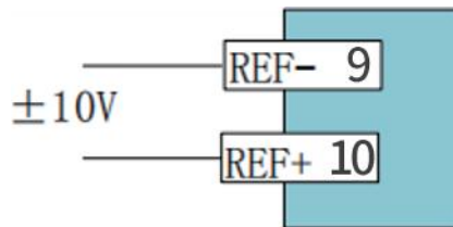
图 4.3.3 内部电源模拟量输入接线
